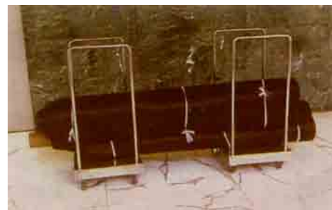
地毯運輸車 (2 部一起使用) 可依據客戶實際環境打造不同尺寸 分體式設計 方便運送較長及重的地毯。
